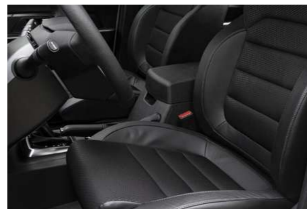
Сиденья с комбинированной обивкой улучшенной конструкции с продольной регулировкой и подогревом, регулировкой по высоте кресла водителя.
