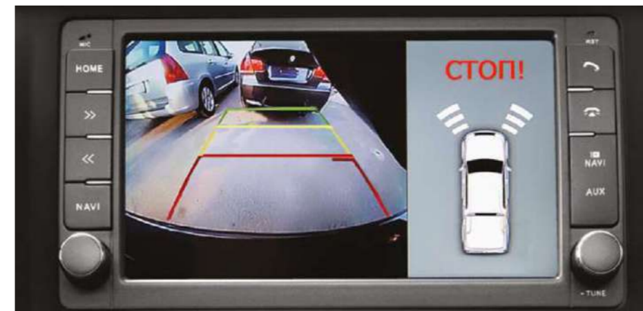
Парковочный ассистент отображает на экране ММС информацию, получаемую от камеры заднего вида
