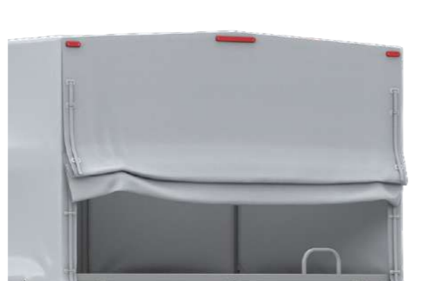
Контурные огни и дополнительный сигнал торможения (для широкой платформы)
