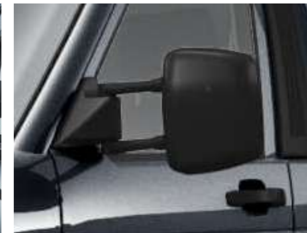
Зеркала с подогревом и электрорегулировкой (для стандартной платформы)
