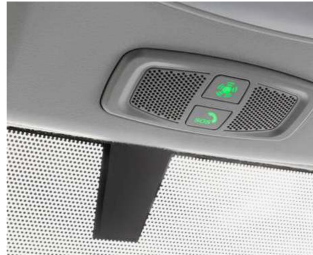
Терминал системы "ЭРА-ГЛОНАСС"
