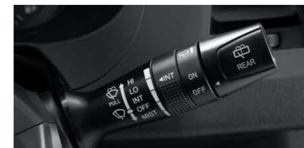
Правый подрулевой переключатель с регулировкой паузы стеклоочистителя
